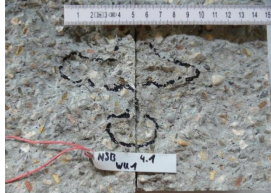
Wassereindringfront bei Stahlfaserzugabe
