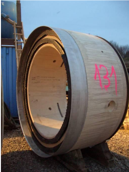
Rohr 131 mit den aufgeklebten EDA-Ringen
